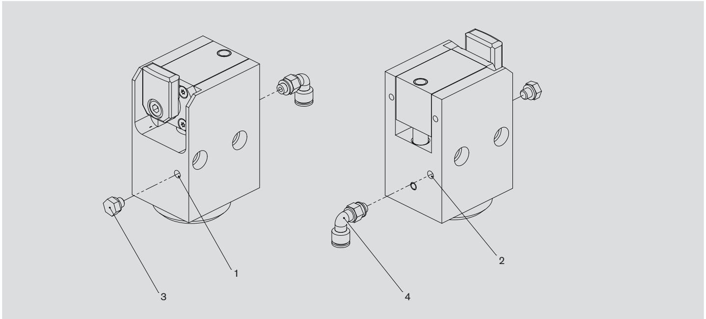
Den Druckluftanschluss "1" oder "2" über Luftanschluss "4" mit dem zugehörigen Schaltventil verbinden. Den freibleibenden Anschluss mit Verschlusschraube M5 "3" verschließen.
