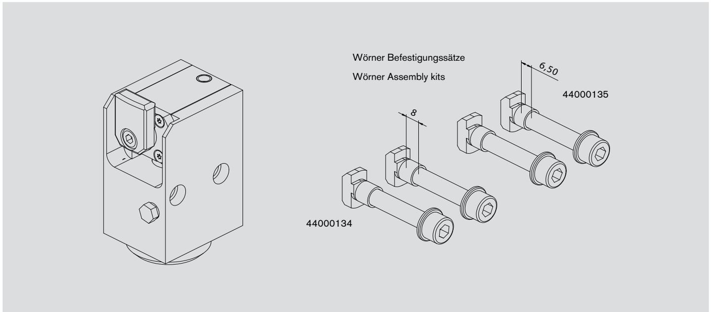
Bei Verwendung von eigenen Befestigungssätzen bitte darauf achten, dass die Festigkeitsklasse min. 8.8 beträgt. Die Einschraubtiefe muss min. 7,5 mm betragen.
