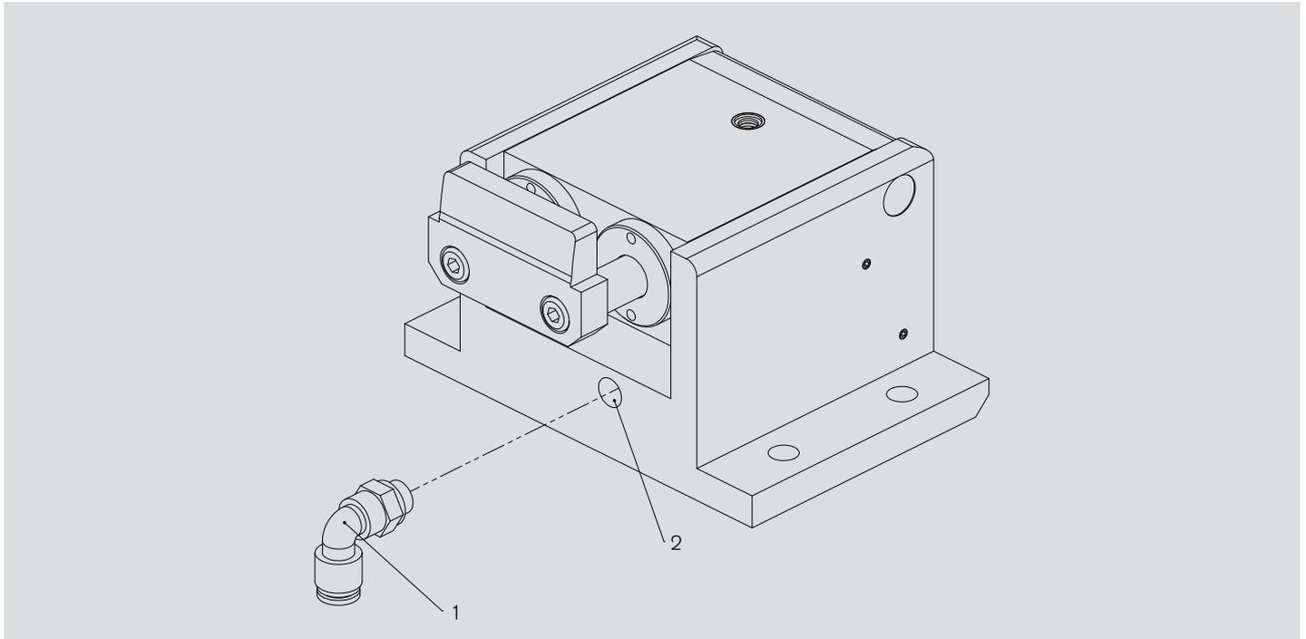
Den Druckluftanschluss (1) über Luftanschluss (2) mit dem zugehörigen Schaltventil verbinden.
