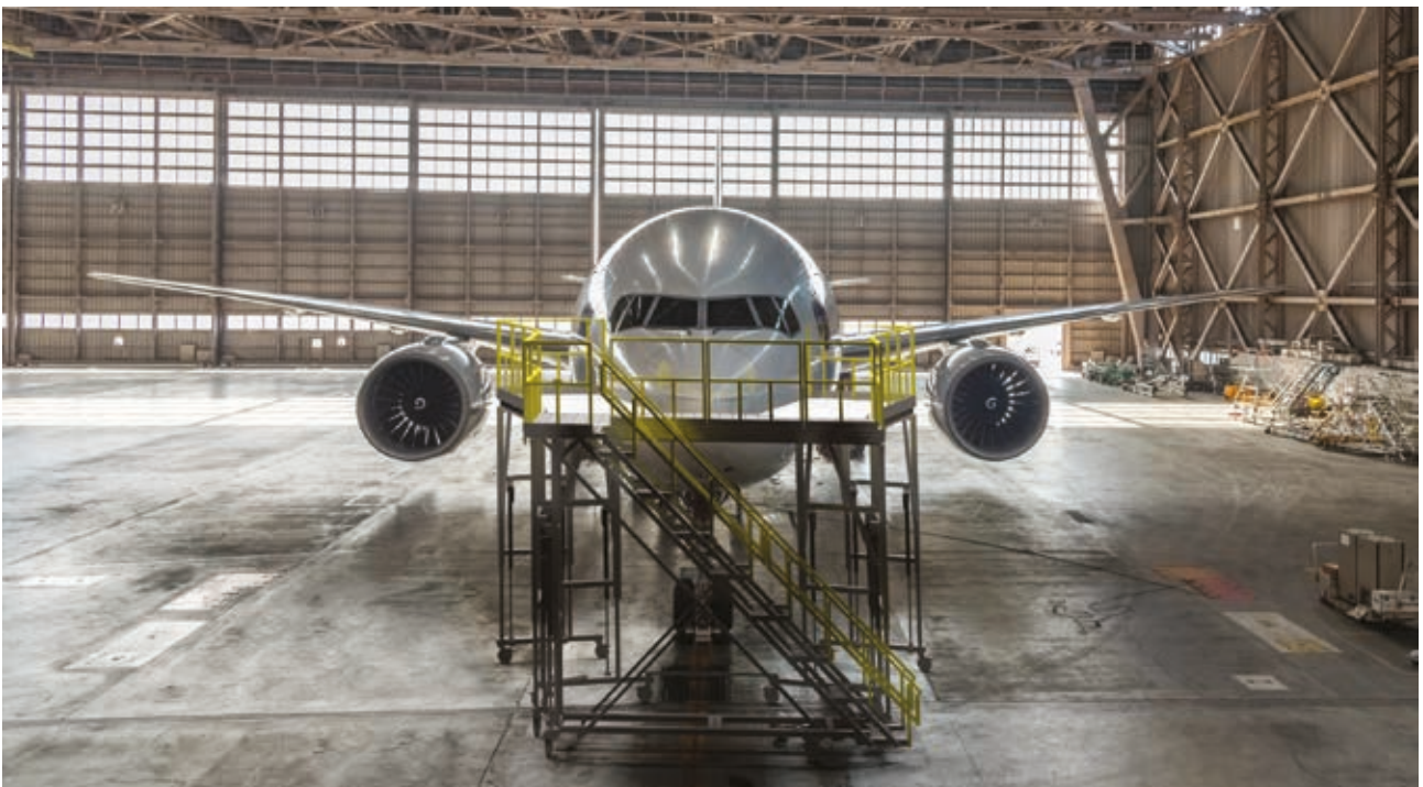
Bei der Positionierung einer Arbeitsbühne können smarte Aktuatoren die Probleme asymmetrischer Lasten ausgleichen, Bewegungen begrenzen und das allgemeine Gefahrenpotenzial senken.
