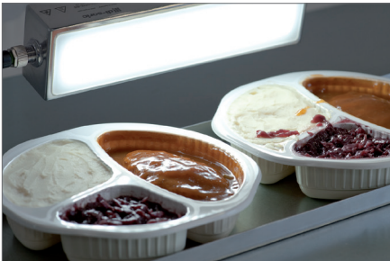
V4A-Auflichtbeleuchtungen zur Qualitätsüberwachung in der Lebensmittelindustrie (BEK 1-A xxxV...) Stainless steel barlights for the quality control within the food & beverage industry (BEK 1-A xxxV...)
