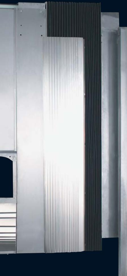
Fix & Finish Komplettabdeckungen werden der kundenspezifischen Führungssituation angepasst. Im unten stehenden Fallbeispiel ist die obere und untere Führung für die X-Faltenbälge durch 2 Winkelbleche realisiert. Innerhalb der X-Abdeckung befindet sich der Z-Rahmen, in dem die Y-Faltenbälge und der Mitnehmer für die Maschine integriert sind. Die Y-Abdeckung wird in einem U-Stahlprofil geführt.
